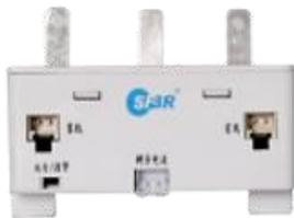
微型电气火灾监控探测器集电压、温度、电流互感器于一体，通过外接卡扣式剩余电流互感器，对引发电气火灾的主要因素（过载、短路、温度、漏电）进行不间断的数据跟踪与统计分析，一旦被监控的线路参数超过预设值即触发报警，并即时向管理人员发送预警信息。
